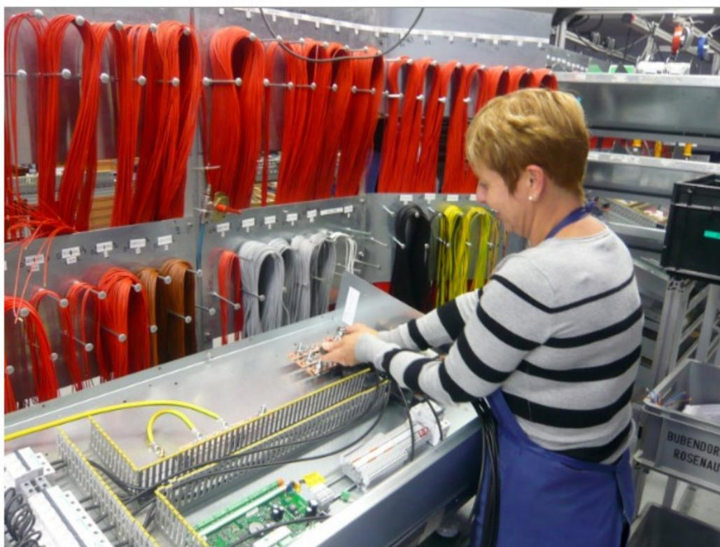
Ici, on découpe du fil et construit des faisceaux, notamment pour le Méhari Cassis Club (distributeur de pièces détachées pour 2 CV), on monte des armoires et assemble des platines pour de nombreux secteurs industriels traditionnels ou en devenir (comme le bornage électrique). Mais on assemble également des composants mécaniques métalliques ou en plastique. Le tout avec les atouts d'une PME digne de ce nom : qualité et réactivité.
